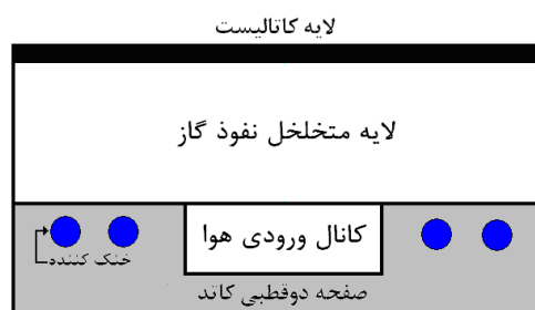
شکل ۱- تصویر شماتیک میدان محاسباتی (جهت جریان در کانال عمود بر صفحه است).
